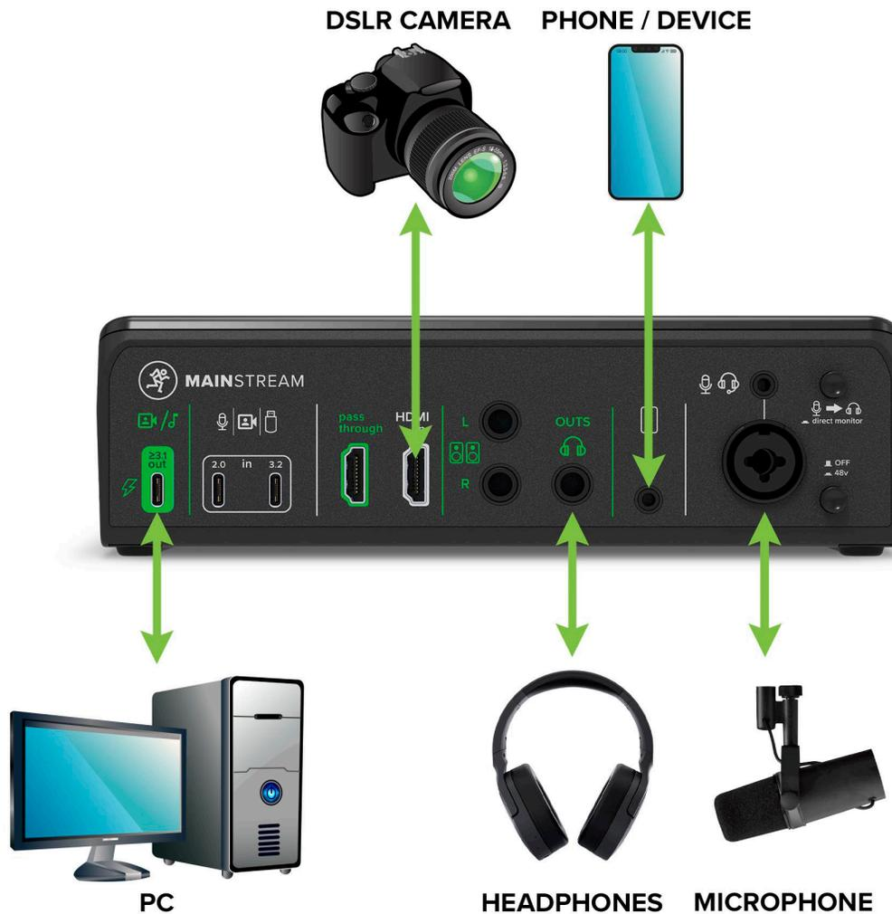
Die Flexibilität des Mackie MainStream macht es zum perfekten Interface für jede Art von Stream. Bei diesem „Einfach Chatten“-Setup werden eine DSLR-Kamera, ein USB-Mikrofon und ein Smartphone zum Chatten mit einem Gastanrufer verwendet. (Mix Minus sorgt dafür, dass der Anrufer kein Echo hört.)
