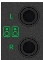
Diese symmetrischen 6,35 mm Stereo-Ausgangsbuchsen werden an die Eingänge von Aktivmonitoren angeschlossen. Das Ausgangssignal ist eine Stereomischung aller Eingänge, einschließlich Kanal I, wenn dessen Direct Monitor-Taste nicht deaktiviert ist. Der Ausgangspegel wird über den Monitorausgangspegelregler auf der Vorderseite des MainStream gesteuert. (Dies ist der kleine Regler auf der rechten Seite des MainStream. Der Aufdruck unter dem Regler zeigt ein Monitorpaar).
