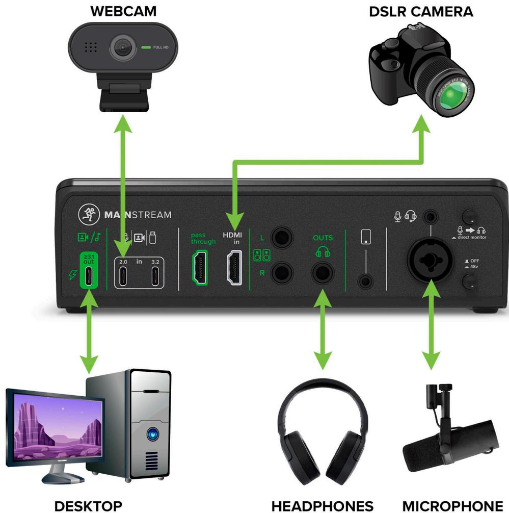
Betreiben Sie eine professionelle Live Streaming Battle Station über das Mackie MainStream, einschließlich einer High-End DSLR-Kamera über HDMI, einer USB-Webcam für einen zusätzlichen Blickwinkel sowie einem hochwertigen XLR-Rundfunkmikrofon und Kopfhörer. Alles wird über ein USB-C-Kabel mit Ihrem PC verbunden.
