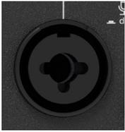
Diese XLR-Buchse kann Mikrofon- oder Line-Pegel-Eingangssignale von fast jeder Art von Quelle verarbeiten. Professionelle Ribbon-, Dynamik- und Kondensatormikrofone klingen alle hervorragend über diesen Eingang. Der Mikrofon-/Line-Pegel-Eingang verkräftet jede Art von eingespeistem Pegel ohne zu übersteuern.
