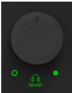
Mit diesem Regler wird die Lautstärke an den 6,35 mm-Kopfhörer- und 3,5 mm-Headset-Ausgängen von ∞ (aus) bis zur maximalen Verstärkung (max.) eingestellt. Achten Sie darauf, dass dieser Regler vollständig zurückgedreht ist, bevor Sie eine neue Quelle auswählen oder hinzufügen.
