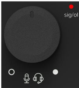
Mit diesem Drehregler wird die Lautstärke von Kanal I – Mikrofon und Headset – zum Kopfhörer und Mix Minus eingestellt.
